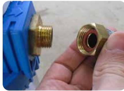
Raccorder le tuyau tricoclair à la sortie du filtre bocal et à l'entrée du groupe de brumisation, puis serrer à l'aide d'une clé plate ou une douille de 7.
