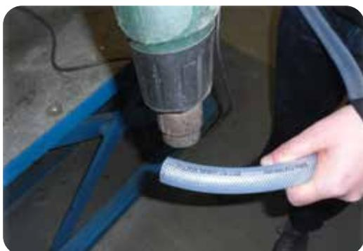
Chauffer l'extrémité du tuyau à l'aide d'un décapeur thermique
