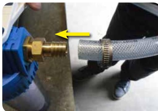
Insérer ensuite le tuyau dans le raccord cannelé (attention risque de brûlure)
